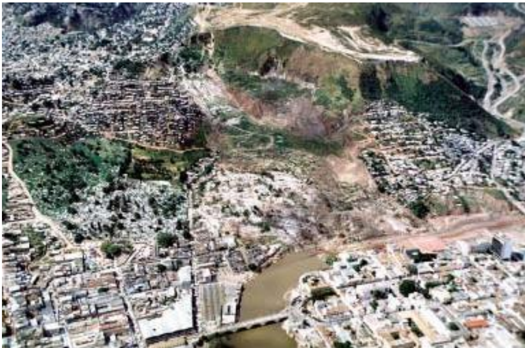
Figura 34. Deslizamientos más grandes en los últimos 20 años en Tegucigalpa, Honduras. Ambos sitios sufrieron reactivaciones significativas durante el Huracán Mitch en octubre de 1998. A. En el deslizamiento de El Reparto, se desplazó un volumen de material de 400,000 \text{ m}^3 . B. En el deslizamiento de El Berrinche, se desplazó un volumen de material de 6,000,000 \text{ m}^3 . Las fotografías aéreas fueron tomadas en el 2001 por el Servicio Geológico de los Estados Unidos (USGS). Proyecto RIESCA.
